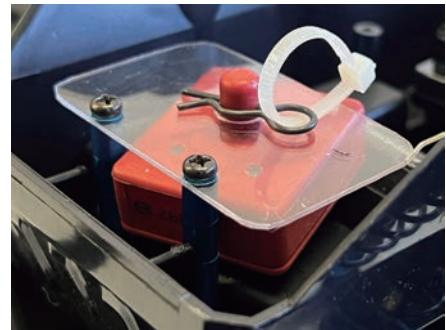
◆マシンが転倒しても発信器が傷つかない位置に取り付けてください。また、ドライブシャフトやベルト、タイヤ等の駆動部分に触れる場所も避けてください。
