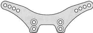
フロントダンパーステー・×1 Front damper stay Vordere Dämpferstrebe Support d'amortisseur avant 4034016
