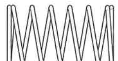
BC13 ×2 19805676 リヤスプリング Rear coil spring Hintere Feder Ressort hélicoïdal arrière
