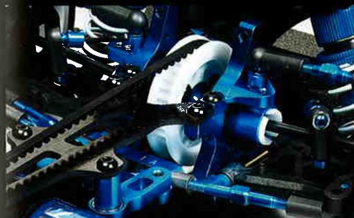
海外レースで主流のフロント・ダイレクトドライブ、リヤ・ボールデフ仕様
