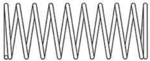
DB1 フロントスプリング Front coil spring Vordere Feder Ressort hélicoïdal avant ×2
